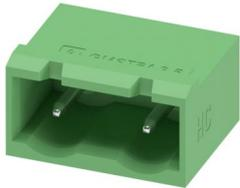
PCB插座，额定横截面: 2.5 mm<sup>2</sup>，颜色: 绿色，额定电流: 16 A，额定电压(III/2): 630 V，触点表面: Sn，触点类型: 针式插头，电位数: 2，行数: 1，位数: 2，连接量: 2，产品系列: GMSTBA 2,5 HC/..-G，针距: 7.62 mm，安装: 波峰焊，针脚排列: 直线排列，焊针[P]: 3.23 mm，每个电势的焊针数量: 1，插拔系统: COMBICON MSTB 2,5 HC，针式连接器样式对齐: 标准，互锁: 不带，安装方式: 不带，包装类型: 纸箱包装
