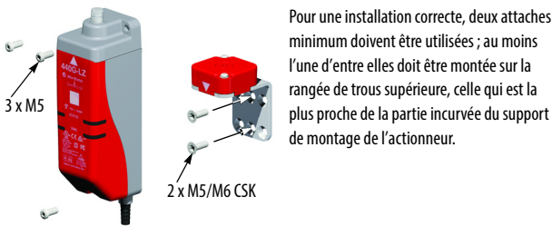
Figure 2 - Corps de la gâche et actionneur
