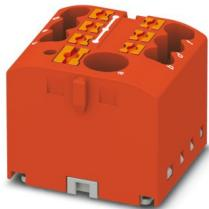
接线板，底座端子及电源，标称工作电压: 450 V，额定电流: 24 A，连接量: 7，接线方式: 直插式连接，负载触点，横截面: 0.14 mm<sup>2</sup> - 4 mm<sup>2</sup>，直插式连接，线路触点，额定接线容量: 6 mm<sup>2</sup>，横截面: 0.5 mm<sup>2</sup> - 10 mm<sup>2</sup>，安装方式: 用于卡接在DIN导轨适配器上，直接安装，带法兰，自由悬挂，颜色: 红色
