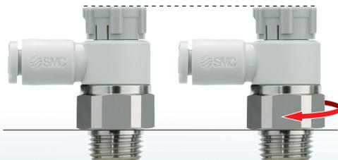
Anzahl der Umdrehungen nach dem Festziehen von Hand **max. 1/6 Umdrehung**
