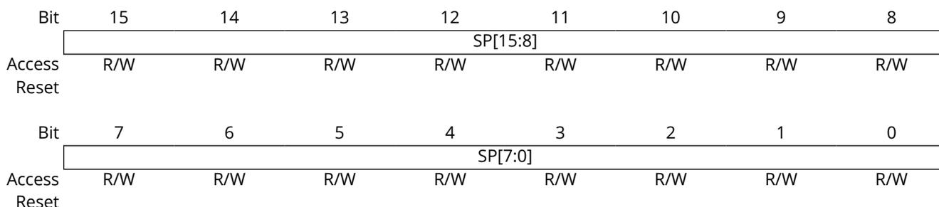
**Bits 15:8 – SP[15:8]** Stack Pointer High Byte
