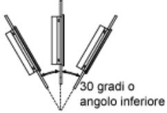
Bei der Montage einer Schalttafel in schräger Position mit einer Neigung von mehr als 30° darf die Umgebungstemperatur 40°C (104°F) nicht übersteigen. Gegebenenfalls müssen Sie eine Gebläseluftkühlung (Ventilator, Klimaanlage) einsetzen, damit eine Umgebungsbetriebstemperatur von höchstens 40°C (104 F) gewährleistet ist.
