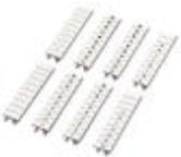
Zackband, Streifen, weiß, beschriftet, längs bedruckt: fortlaufende Zahlen 1-10, 11-20 usw. bis 491-500, Montageart: Verrasten in hoher Schildchennut, für Klemmenbreite: 5,2 mm, Schriftfeldgröße: 5,15 x 10,5 mm
