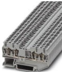
Durchgangsklemme, Anschlussart: Zugfederanschluss, Querschnitt: 0,08 mm<sup>2</sup> - 4 mm<sup>2</sup>, AWG: 28 - 12, Breite: 5,2 mm, Farbe: grau, Montageart: NS 35/7,5, NS 35/15
