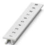
Nastro Zack, Striscia, bianco, siglato, siglabile con: CMS-P1-PLOTTER, siglatura longitudinale: numeri progressivi 1 ...10, 11 ...20 ecc. fino a 491 ...500, tipo di montaggio: inserimento a scatto in scanalatura alta portacartellini, per morsetti con spessore: 6,2 mm, dimensioni campo di siglatura: 6,15 x 10,5 mm
