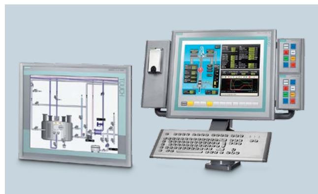
SIMATIC Flat Panel Monitor PRO 19" und HMI IPC477C PRO 15" mit Erweiterungseinheiten inkl. SIMATIC HMI Key Panels
