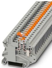
刀闸分断接线端子，带测试插座螺栓，用于插入测试插头，标称工作电压: 500 V，额定电流: 20 A，接线方式: 螺钉连接，额定接线容量: 2.5 mm<sup>2</sup>，接线容量：0.14 mm<sup>2</sup> - 6 mm<sup>2</sup>，安装: NS 35/7,5，NS 35/15，颜色: 灰色
