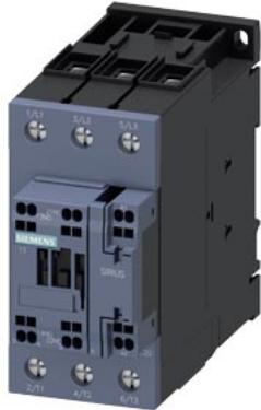
Leistungsschütz, AC-3e/AC-3, 51 A, 22 kW / 400 V, 3-polig, DC 24 V, 0,8-1,2\* Us, mit integriertem Varistor, Hilfskontakte: 1 S + 1 Ö, Hauptstromkreis: Schraubanschluss, Steuer- und Hilfstromkreis: Federzuganschluss, Baugröße: S2, geeignet für SPS-Ausgänge
