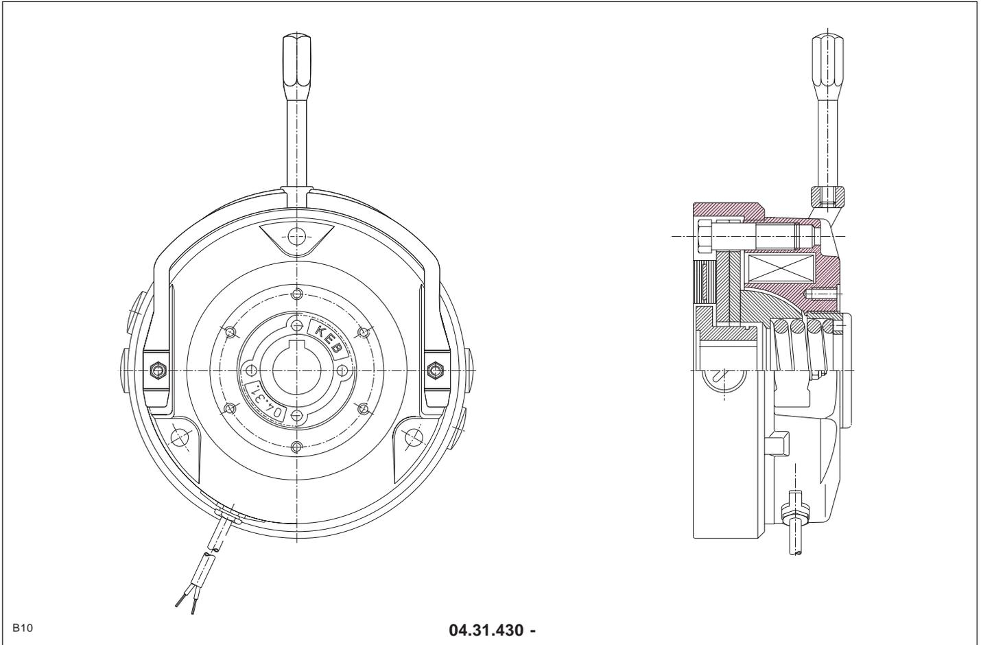
Für den Anbau eines Tachogenerators steht eine abgewandelte KEB COMBISTOP zur Verfügung. Die Tachobremse erlaubt den direkten Anbau eines Hohlwellen Tachogenerators. Die fest montierte Tachohaube und die rückseitige Anschraubfläche werden so bearbeitet, daß keine unzulässigen Plan- und Rundlaufabweichungen auftreten.
