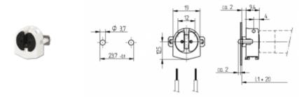
L1 + 20: La misura si riferisce all'impiego di un portalampada senza e di uno con molla a lamina. Nella determinazione definitiva della distanza dei fori si deve di volta in volta tener conto delle dimensioni della lampada e dell'apparecchio di illuminazione.
