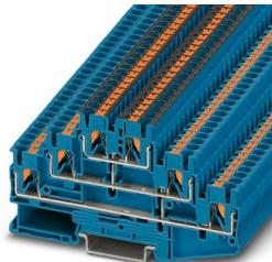
多层接线端子，带等电位连接，标称工作电压: 500 V，额定电流: 20 A，连接量: 6，接线方式: 直插式连接，第1, 2和第3层，额定接线容量: 2.5 mm<sup>2</sup>，横截面: 0.14 mm<sup>2</sup> - 4 mm<sup>2</sup>，安装方式: NS 35/7,5, NS 35/15，颜色: 蓝色
