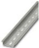
Tragschiene gelocht, Standardprofil, Breite: 35 mm, Höhe: 7,5 mm, nach EN 60715, Material: Stahl, verzinkt, dickschichtpassiviert, Länge: 2000 mm, Farbe: silber
