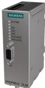
PROFIBUS OLM/G12 V4.0 Optical Link Module mit 1 RS-485 und 2 Glas- LWL-Schnittstellen (4 BFOC-Buchsen) für Standard- Entfernungen bis 2850m, mit Meldekontakt und Messausgang.
