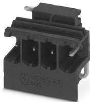
PCB插座，额定横截面: 2.5 mm<sup>2</sup>，颜色: 黑色，额定电流: 16 A，额定电压(III/2): 320 V，触点表面: Sn，触点类型: 针式插头，电位数: 4，行数: 1，位数: 4，连接量: 4，产品系列: MSTBO 2,5/..-G1PL，针距: 5 mm，安装: 波峰焊，针脚排列: 直线排列，焊针[P]: 3.5 mm，每个电势的焊针数量: 1，插拔系统: COMBICON MSTB 2,5，针式连接器样式对齐: 垂直，互锁: 不带，包装类型: 纸箱包装，产品左侧带有针式插头输出
