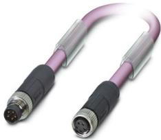
Bussystem-Kabel, CANopen®, DeviceNet™, 5-polig, PUR halogenfrei, violett RAL 4001, geschirmt, Stecker gerade M8, Kodierung: B, auf Buchse gerade M8, Kodierung: B, Kabellänge: 0,3 m, Steckverbinder ungeschirmt
