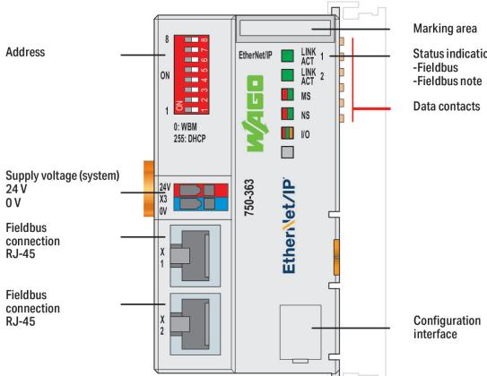
L'accoppiatore fieldbus EtherNet/IP 750-363 collega il sistema fieldbus EtherNet/IP al sistema modulare di I/O della WAGO.
