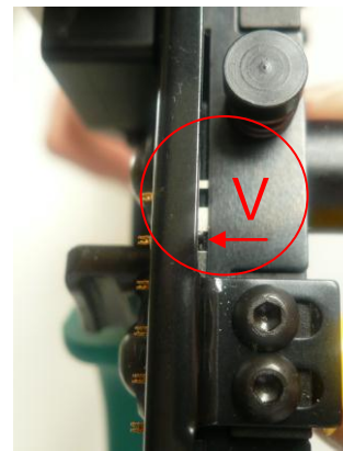
The feed pin engages with strip lock. Der Vorschubstift rastet mit der Kontaktstreifenverriegelung ein.
