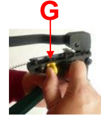
Effect the insert until contact is in the middle (M) of the crimping profile. Kontaktstreifen vorschieben bis Kontakt in der Mitte vom Crimpprofil liegt (M).
