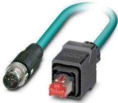
Câble de réseau, Ethernet CAT5 (100 Mbit/s), 4-pôles, Type de câble variable, blindé, connecteur mâle droit M12 SPEEDCONNECT / IP67, détrompage: D, sur connecteur mâle droit RJ45 Push-Pull / IP67, longueur de câble: Longueur au choix (0,2... 40,0 m)
