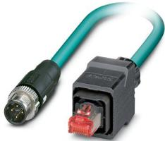
Câble de réseau, Ethernet CAT5 (100 Mbit/s), 4-pôles, blindé, connecteur mâle droit M12 SPEEDCONNEC / IP67, détrompage: D, sur connecteur mâle droit RJ45 Push-Pull / IP67, longueur de câble: 1 m
