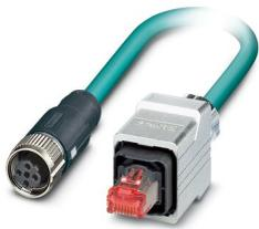
Câble de réseau, Ethernet CAT5 (100 Mbit/s), 4-pôles, Type de câble variable, blindé, connecteur mâle droit RJ45 Push-Pull / IP67, sur connecteur femelle droit M12 SPEEDCONNEC / IP67, détrompage: D, longueur de câble: Longueur au choix (0,2... 40,0 m)
