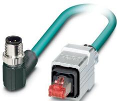
Câble de réseau, Ethernet CAT5 (100 Mbit/s), 4-pôles, Type de câble variable, blindé, connecteur mâle coudé M12 SPEEDCONNECT / IP67, détrompage: D, sur connecteur mâle droit RJ45 Push-Pull / IP67, longueur de câble: Longueur au choix (0,2... 40,0 m)
