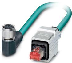
Câble de réseau, Ethernet CAT5 (100 Mbit/s), 4-pôles, Type de câble variable, blindé, connecteur mâle droit RJ45 Push-Pull / IP67, sur connecteur femelle coudé M12 SPEEDCONNEC / IP67, détrompage: D, longueur de câble: Longueur au choix (0,2... 40,0 m)
