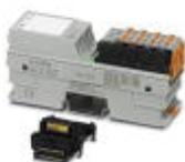
Axioline F, Module d'entrée et de sortie analogiques, Entrées analogiques: 2, 0 V ... 5 V, -5 V ... 5 V, 0 V ... 10 V, -10 V ... 10 V, 0 mA ... 20 mA, 4 mA ... 20 mA, -20 mA ... 20 mA, connectique: 2 fils, Sorties analogiques: 2, 0 V ... 5 V, -5 V ... 5 V, 0 V ... 10 V, -10 V ... 10 V, 0 mA ... 20 mA, 4 mA ... 20 mA, -20 mA ... 20 mA, connectique: 2 fils, vitesse de transmission dans le bus local: 100 MBit/s, indice de protection: IP20, incl. module d'embase de bus et connecteurs Axioline F
