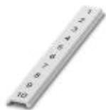
クイックマーカー、平面式、ラベリング、白、マーキングあり、縦方向に印字: 連番 ( 1 ... 10、11 ... 20など、91 ... 100まで )、取付けタイプ: 平面マーキング溝にスナップ止め、端子台幅 : 5 mm、印字エリア: 5.15 x 5.15 mm
