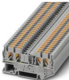
接続式端子台、定格電圧: 800 V、定格電流: 24 A、接続方式: プッシュイン式、接続数: 4、断面積: 0.14 mm<sup>2</sup> - 4 mm<sup>2</sup>、AWG: 26 - 12、幅: 5.2 mm、高さ: 35.3 mm、色: 灰、取付けタイプ: NS 35/7,5、NS 35/15
