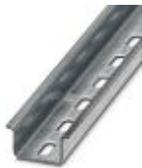
DINレール、取付け穴あり、標準プロファイル、幅: 35 mm、高さ: 15 mm、EN 60715に類似、部材: スチール、亜鉛メッキ、長さ: 2000 mm、色: 銀
