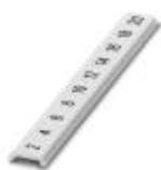
クイックマーカー、平面式、ラベリング、白、マーキングあり、横方向に印字: 連番 ( 2 ... 20、22 ... 40など、82 ... 100まで )、取付けタイプ: 平面マーキング溝にスナップ止め、端子台幅 : 5 mm、印字エリア: 5.15 x 5.15 mm
