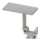
グループマーキングラベル、ネジ/スプリング/圧接接続式端子台中央部にスナップ止め、25 x 12 mmのラベルでマーキングするかB-STIFTで手書き、脚部にはZB 5を使用
