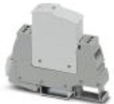
Protección contra sobretensiones de tipo 2/3, formada por protección enchufable y elemento de base, con indicador de estado e indicación remota integrados para redes de fuente de alimentación monofásicas. Tensión nominal: 230 V AC/DC.
