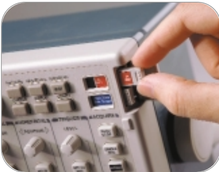
► Installation d'un module d'application.
