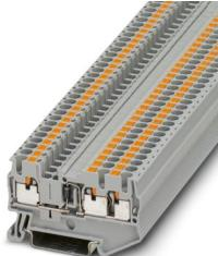
元件端子，集成1N4007二极管，标称工作电压: 800 V，额定电流: 0.5 A，连接量: 3，接线方式: 直插式连接，额定接线容量: 2.5 mm<sup>2</sup>，横截面: 0.14 mm<sup>2</sup> - 4 mm<sup>2</sup>，安装方式: NS 35/7,5，NS 35/15，颜色: 灰色
