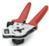
圧着ペンチ、Ø 0.6 mm / Ø 0.8 mm / Ø 1 mm / Ø 2 mmのマシン型圧着コンタクト用、ばら線断面積0.06 ... 2.5 mm<sup>2</sup>
