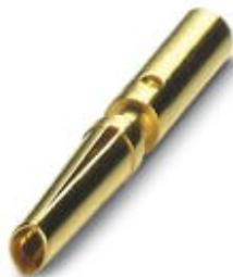
圧着コンタクト、マシン型、コンタクト径: 0.8 mm、圧着範囲: 0.08 mm<sup>2</sup> ... 0.25 mm<sup>2</sup>
