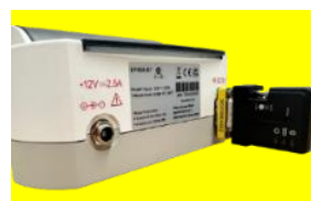
Connexion de l'adaptateur Bluetooth sur l'imprimante
