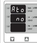
In diesem Bereich wird festgelegt ob die Messanzeige immer die aktuell gewählten Werte anzeigen oder alle Werte automatisch nacheinander dargestellt werden. Mit der Taste „AUF“ wird die aktuelle Einstellung beibehalten. Mit der Taste „AB“ werden die Einstellmöglichkeiten aufgerufen.
