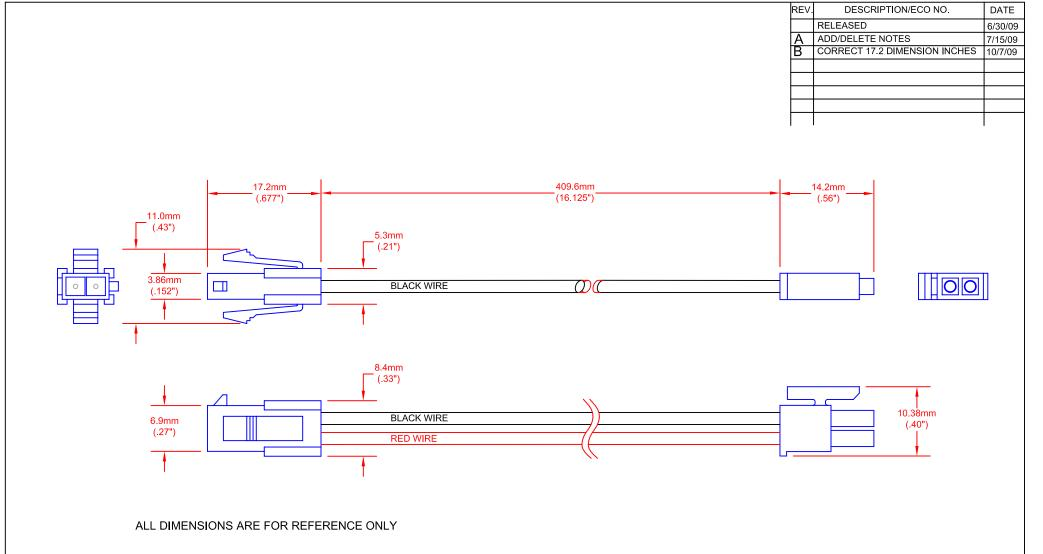
JUMPER CONNECTOR MATES WITH JKL ZAF ALUMILINE SERIES LED LIGHT BARS.
