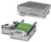
Connecteur mâle D-SUB , à 9 pôles, femelle, deux arrivées de câble inférieures à 35°, système de bus : CAN, SUCONET K1, K2 (MOELLER), S-BUS (Saia), J-BUS (Merlin Gerin), brochage : 2, 3, 4, 5, 7, 9 sur deux blocs de jonction à vis chacun
