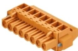
Connecteurs femelles avec raccordement vissé en technique de raccordement à étrier pour le raccordement du conducteur avec orientation de sortie perpendiculaire (90° ou 270°). Les connecteurs femelles disposent d'espace pour les marquages et peuvent être codés. Fixation par bride ou griffe. Ils disposent en plus de vis plus/moins intégrées, d'une protection contre le mauvais enfichage du fil et sont livrés avec les étriers ouverts.
