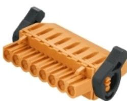
Connecteurs femelles avec raccordement vissé en technique de raccordement à étrier pour le raccordement du conducteur avec orientation de sortie perpendiculaire (90° ou 270°). Les connecteurs femelles disposent d'espace pour les marquages et peuvent être codés. Fixation par bride ou griffe. Ils disposent en plus de vis plus/moins intégrées, d'une protection contre le mauvais enfichage du fil et sont livrés avec les étriers ouverts.
