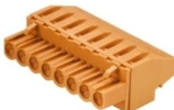
Connecteurs femelles avec raccordement vissé en technique de raccordement à étrier pour le raccordement du conducteur avec orientation de sortie perpendiculaire (90° ou 270°). Les connecteurs femelles disposent d'espace pour les marquages et peuvent être codés. Fixation par bride ou griffe. Ils disposent en plus de vis plus/moins intégrées, d'une protection contre le mauvais enfichage du fil et sont livrés avec les étriers ouverts.
