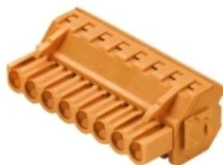
Connexion à étrier pour raccordement de fil à la perpendiculaire ou en biais (90°/270° ou 225°). Les connecteurs femelles disposent d'espace pour les marquages et peuvent être codés. Fixation par bride ou griffe. Ils disposent en plus de vis plus/moins intégrées, d'une protection contre le mauvais enfichage du fil et sont livrés avec les étriers ouverts.
