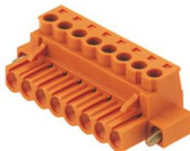
Connecteurs femelles avec raccordement vissé en technique de raccordement à étrier pour le raccordement de conducteurs avec orientation de sortie droite et bride à visser. Les connecteurs femelles disposent d'espace pour les marquages et peuvent être codés.
