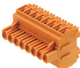
Connecteurs femelles avec deux raccordements vissés par pôle, avec technique de raccordement à étrier, pour le raccordement du conducteur avec orientation de sortie à 90° et 270°. Les connecteurs femelles disposent d'espace pour les marquages et peuvent être codés.
