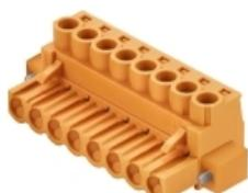
Connecteurs femelles avec raccordement vissé en technique de raccordement à étrier pour le raccordement du conducteur avec orientation de sortie droite (180°). Les connecteurs femelles disposent d'espace pour les marquages et peuvent être codés. Fixation par bride ou griffe. Ils disposent en plus de vis plus/moins intégrées, d'une protection contre le mauvais enfichage du fil et sont livrés avec les étriers ouverts.
