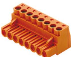
Connecteurs femelles avec raccordement vissé en technique de raccordement à étrier pour le raccordement du conducteur avec orientation de sortie droite (180°). Les connecteurs femelles disposent d'espace pour les marquages et peuvent être codés.
