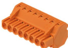
Connecteurs femelles avec raccordement vissé en technique de raccordement à étrier pour le raccordement du conducteur avec une orientation de sortie à 225°. Les connecteurs femelles disposent d'espace pour les marquages et peuvent être codés.
