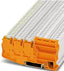
建筑安装用接地端子，标称工作电压: 250 V，额定电流: 30 A，连接量: 5，接线方式: 回拉式弹簧连接，额定接线容量: 2.5 mm<sup>2</sup>，横截面: 0.08 mm<sup>2</sup> - 4 mm<sup>2</sup>，安装方式: NS 35/7,5，NS 35/15，颜色: 橙色
