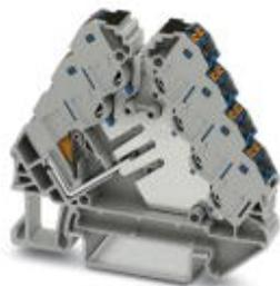
Distributeurs de potentiel, avec alimentation possible jusqu'à 6 mm<sup>2</sup>, Tension nominale: 250 V, Intensité nominale: 17,5 A, Section : 0,14 mm<sup>2</sup> - 2,5 mm<sup>2</sup>, AWG: 14 - 26, Mode de raccordement: Raccordement Push-in, Nombre de pôles: 2, Nombre de connexions: 13, Largeur: 8,3 mm, Longueur: 64 mm, Coloris: gris, Couleur des éléments de raccordement: bleu, Montage: NS 35/7,5, NS 35/15
