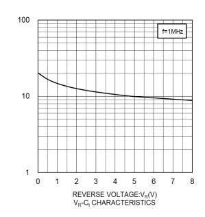
CAPACITANCE BETWEEN TERMINALS:C<sub>t</sub>(pF)
