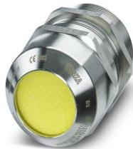
电缆密封，螺钉连接材料: 镀镍铜，应用: Ex，电缆外径 21 mm ... 35 mm，屏蔽: 无，连接螺纹: M50 x 1.5，颜色: 银色，带O型圈
