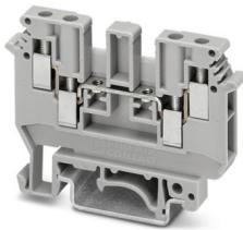
直通式接线端子，标称工作电压: 630 V，额定电流: 32 A，连接量: 4，位数: 1，接线方式: 螺钉连接，额定接线容量: 4 mm<sup>2</sup>，横截面: 0.2 mm<sup>2</sup> - 6 mm<sup>2</sup>，安装方式: NS 35/7,5，NS 35/15，NS 32，颜色: 灰色
