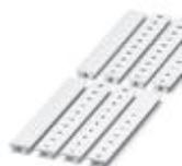
Marcador para bornes, Tiras, blanco, rotulado, rotulable con: CMS-P1-PLOTTER, Longitudinal: L1, L2, L3, N, PE, L1, L2, L3, N, PE, clase de montaje: encajar en ranura para índice alta, para ancho de borne: 8,2 mm, superficie útil: 10,5 x 8,15 mm
