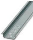
Carril simétrico sin perforar, Perfil estándar, anchura: 35 mm, altura: 7,5 mm, según EN 60715, material: Aluminio, sin recubrimiento, longitud: 2000 mm, color: plateado
