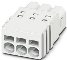
Leiterplattenstecker, Nennquerschnitt: 0,5 mm<sup>2</sup>, Farbe: weiß, Nennstrom: 6 A, Bemessungsspannung (III/2): 160 V, Kontaktobерfläche: Sn, Kontaktart: Buchse, Anzahl der Potenziale: 4, Anzahl der Reihen: 1, Polzahl: 4, Anzahl der Anschlüsse: 4, Artikelfamilie: PTSM 0,5/..-P WH, Rastermaß: 2,5 mm, Anschlussart: Push-in-Federanschluss, Anschlussrichtung Leiter/Platine: 0 °, Stecksystem: COMBICON PTSM, Verriegelung: ohne, Befestigungsart: ohne, Verpackungsart: verpackt im Karton
