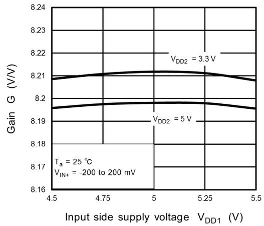
**Fig. 12.4  $G - V_{DD1}$**
