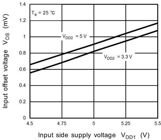
**Fig. 12.1  $V_{OS} - V_{DD1}$**
