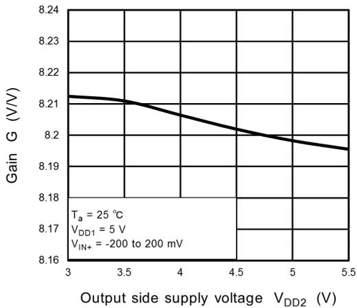
**Fig. 12.5  $G - V_{DD2}$**
