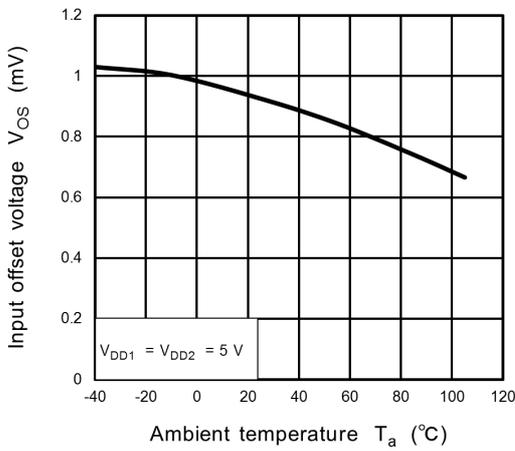
**Fig. 12.3  $V_{OS} - T_a$**
