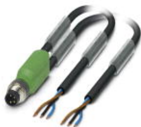
センサ/アクチュエータケーブル, 3-極, PUR ハロゲンフリー, 黒-灰RAL 7021, プラグ ストレート M8, 上 片側フリー および 片側フリー, ケーブル長: 5 m
