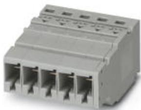
COMBI-Kupplung, Anschlussart: Push-in- / Steckanschluss, Anzahl der Anschlüsse: 2, Polzahl: 4, Querschnitt: 0,5 mm<sup>2</sup> - 10 mm<sup>2</sup>, AWG: 20 - 8, Breite: 32,8 mm, Höhe: 24,7 mm, Farbe: grau
