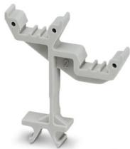
标记槽，卡接到ST 1,5...回拉式弹簧端子，可使用UC-TM 4、UC-TMF 4、UCT-TM 4、UCT-TMF 4、ZB 4或ZBF 4进行标记，灰色，未标记，安装方式：锁扣，文本框高度：10.5 mm，文本框宽度：4 mm
