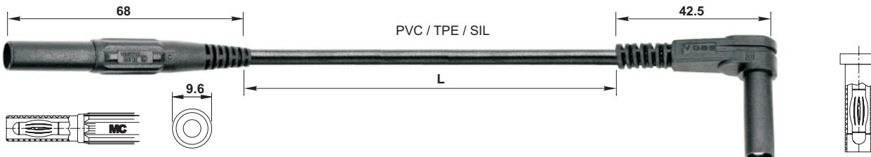
Hoch flexible Messleitungen mit PVC-, TPE oder Silicon-Isolierung. Eine Seite axialer Ø 4 mm-Lamellenstecker mit starrer Isolierhülse. Andere Seite 90° abgewinkelter Ø 4 mm-Lamellenstecker mit starrer Isolierhülse. Durch den sehr hohen Isolationswiderstand der TPE-Isolierung eignet sich die Messleitung XMT-484 hervorragend für hochohmige Widerstandsmessungen.
