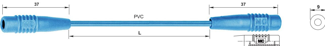
Hoch flexible Kupplungsleitungen, beidseitig mit starrer Ø 4 mm-Buchse.
