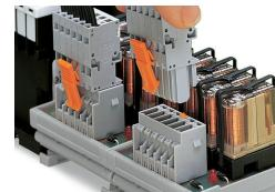
Connexion enfichable des circuits imprimés
