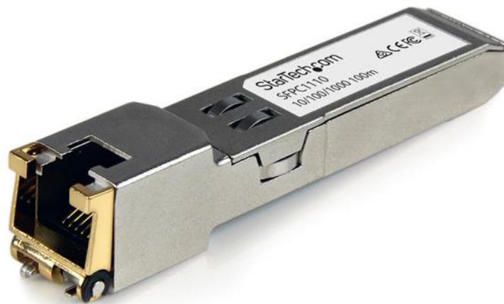
El modelo SFPC1110 es un módulo transceptor por cobre, compatible con el modelo SFP-GE-T de Cisco, diseñado, programado y probado para su funcionamiento con enrutadores y conmutadores de la marca Cisco®. Ofrece conectividad 1GbE (1000Mbps) fiable a través de cable de cobre para redes compatibles con 1000BASE-T, con una distancia máxima de hasta 100m.
