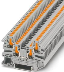
直通式接线端子，标称工作电压: 800 V，额定电流: 24 A，连接量: 4，接线方式: 直插式连接，额定接线容量: 2.5 mm<sup>2</sup>，横截面: 0.14 mm<sup>2</sup> - 4 mm<sup>2</sup>，安装方式: NS 35/7,5，NS 35/15，颜色: 灰色
