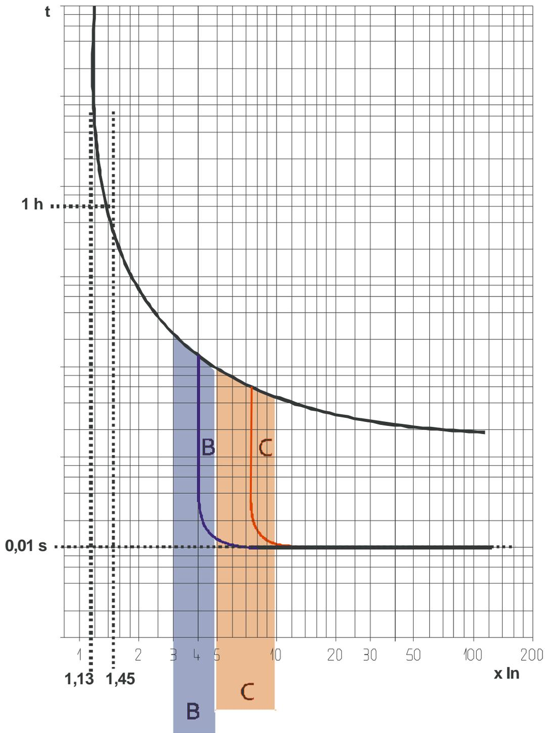
Déclenchement thermique à température ambiante = 30°C
