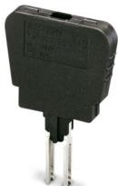
保险丝插头，标称工作电压: 24 V，额定电流: 6.3 A，接线方式: 直插式连接，深度: 45.7 mm，宽度: 6.1 mm，高度: 33.1 mm，颜色: 黑色
