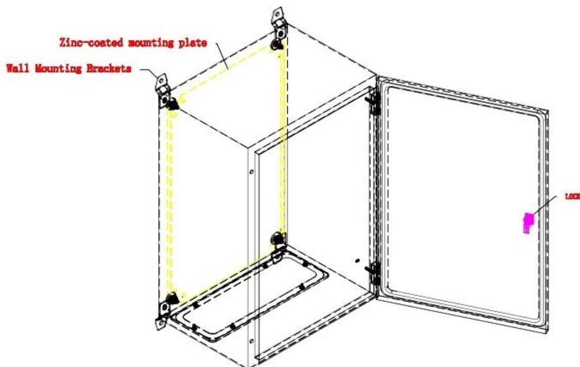
**Aplicación:** Una caja de pared industrial IP66 de acero templado adecuada para alojar equipos electrónicos y eléctricos en entornos exigentes, donde la zona es propensa a mangueras frecuentes o condiciones generalmente húmedas.
